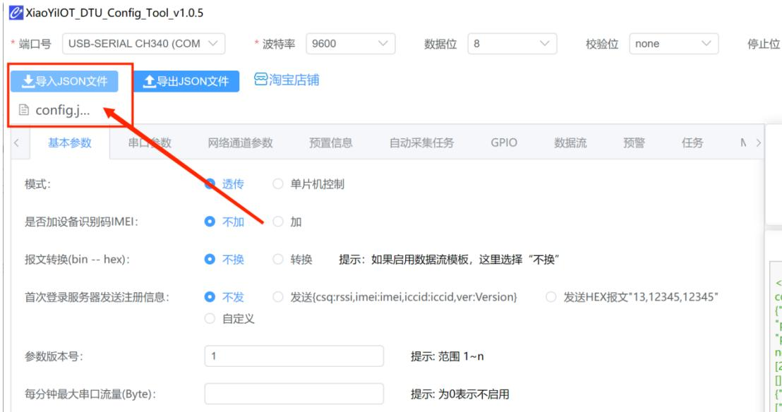
注意：“导入 JSON 文件”功能只是将 JSON 文件中的配置参数解析到页面中，并非直接写入到网关中，因此还需要执行“写入配置”才会将配置写入到设备中去。此外，modbus 配置需要在该配置页面中单独进行导入导出操作，如下。
